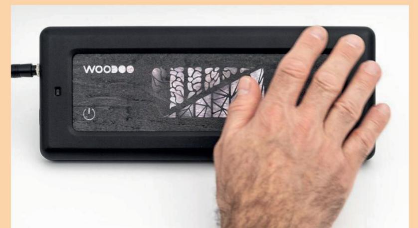
**LE SWITCHR** Une technologie pour concevoir des panneaux de contrôle et des interfaces en bois avec une commande tactile ou gestuelle. Déjà disponible dans sept essences de bois différentes, ce Switchr peut être utilisé dans l'électronique, l'aéronautique, l'automobile, l'électroménager...
